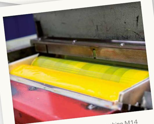
Farbwerk in Gelb auf der Druckmaschine M14
