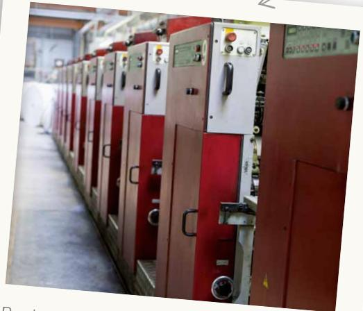
Druckmaschine M14 mit 10 Farbwerken
