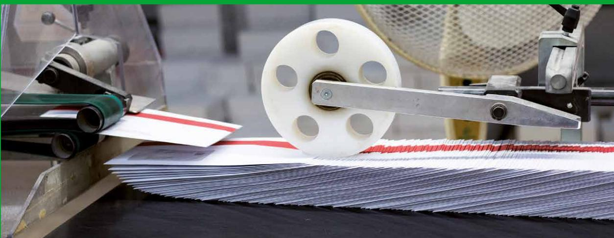
Am Ende der Kuvertieranlage werden die Kuvertmailing versandfertig gesammelt.
