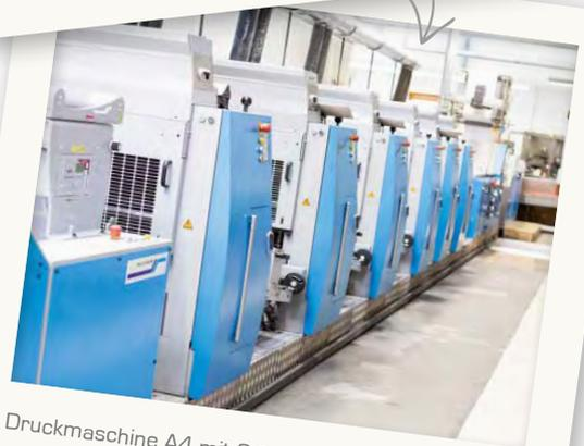
Druckmaschine A4 mit 6 Farbwerken
